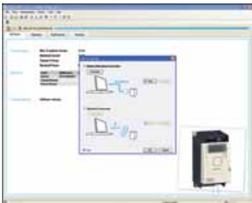
Пример использования ПО SoMove с преобразователем частоты ATV 12
