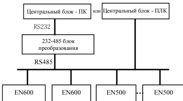
Рис.А-1 Схема построения сети
